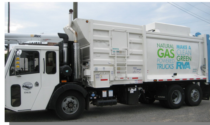
משאית מונעת בגז טבעי דחוס (CNG).
