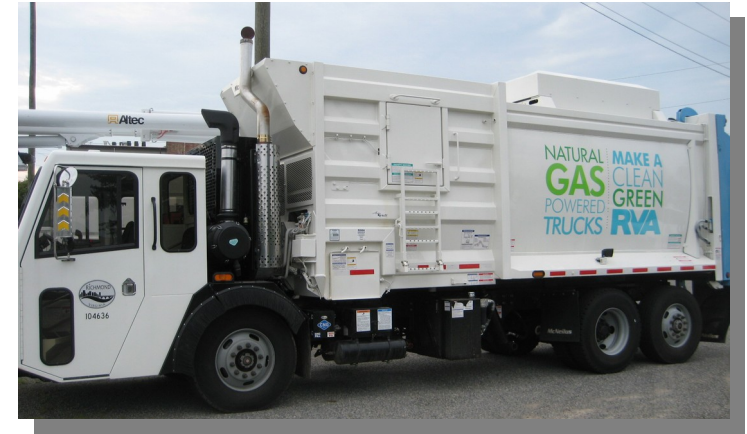
משאית מונעת בגז טבעי דחוס (CNG).
